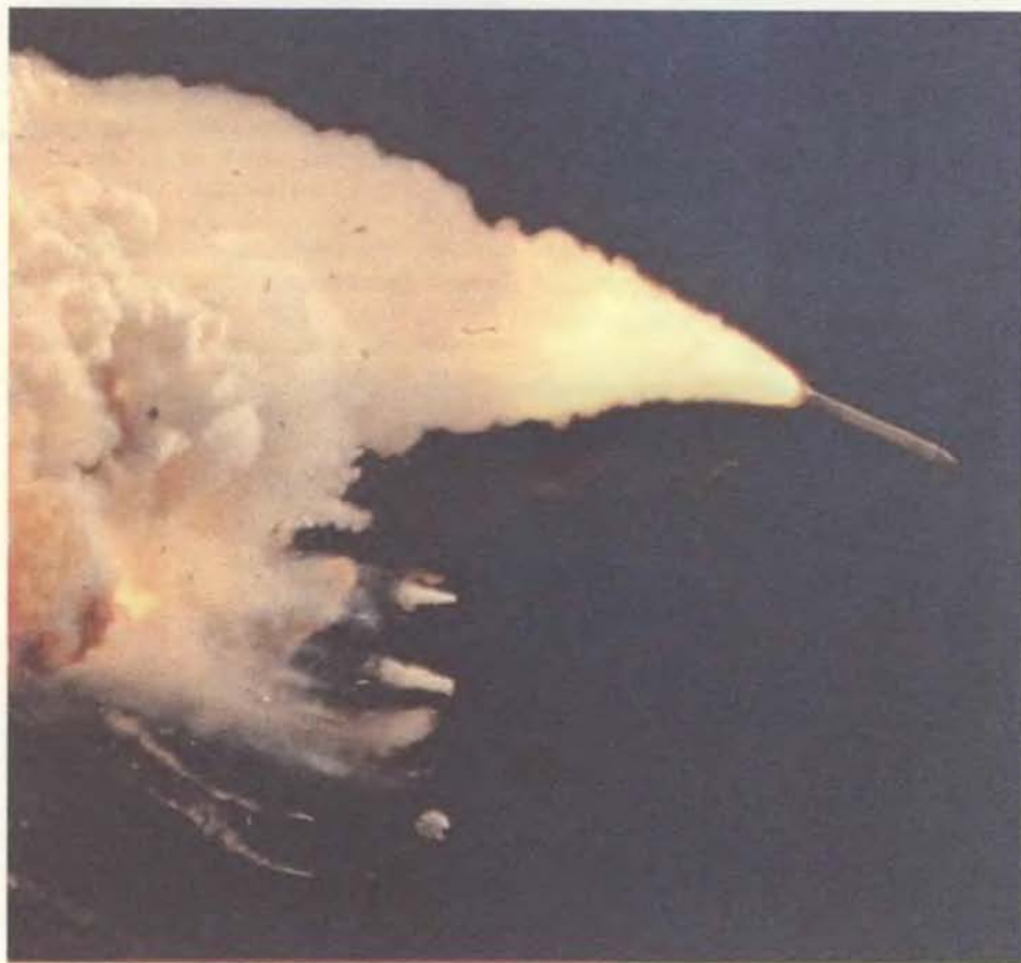
КАТАСТРОФА С «ЧЕЛЛЕНДЖЕРОМ», происшедшая в январе прошлого года, нарушила выполнение программы космических исследований в США. На фотографии из отчета президентской комиссии по расследованию причин катастрофы виден левый стартовый двигатель, уносящийся от облака дыма вокруг разрушающегося корабля.
