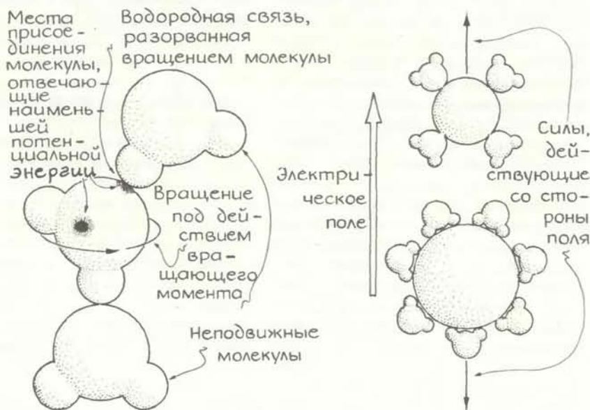
Силы, действующие на гидратированные ионы
